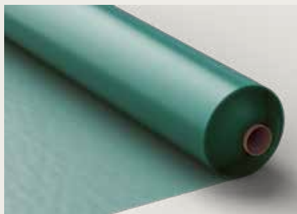
PE-FOLIE (POLYETHYLEEN) 12,5 × 2,7 m = 33,75 m 2 /rol. Beschermt de vloer tegen vocht dat vanaf een mineralen of betonnen onderliggende vloer opstijgt. Nuttige levensduur 50 jaar.
